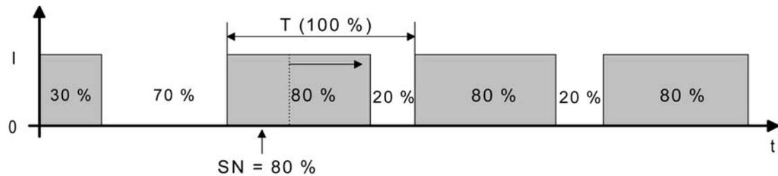
Bild 20: Stellgrößenänderung z. B. von 30 % auf 80 % während Öffnungsphase des Ventils
