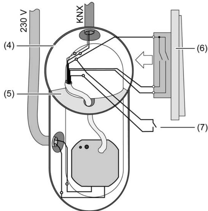
Bild 3: Montage des Gerätes in einer Elektronik-Dose (Beispiel)
