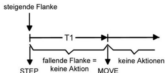
Bild 7: Bedienkonzept "Lang - Kurz"
